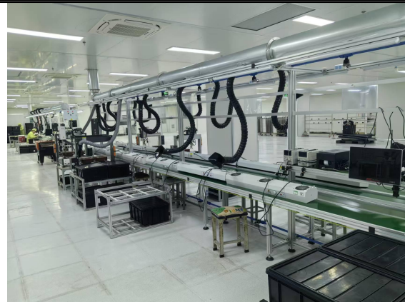
焊接废气集气罩及收集管道
