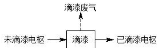
图 2-9 滴漆工艺流程图
